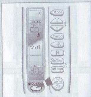
После выбора режима good'sleep функция таймер выключения автоматически выключит кондиционер через 8 часов. Вы также можете нажать кнопку , чтобы установить действие таймера выключения в пределах от 30 минут до 12 часов. Затем, для подтверждения данной установки нажмите кнопку . В течение периода режима good'sleep, диапазон доступной температуры составляет от 16°C до 30°C. При этом, скорость вентилятора и воздушные потоки не регулируются.
